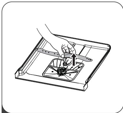
**2** Para retirar o braço aspersor inferior, segure na parte central e levante.
