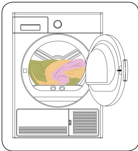
**● IMPORTANTE:** No se recomienda cargar la secadora con más ropa que la que se muestra en la ilustración. En caso de sobrecargar la secadora, se reduce su función de secado y tanto la secadora como las prendas podrían resultar dañadas.
