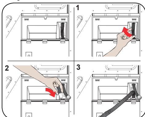
**! ATENÇÃO:** A mangueira deverá ser conectada de forma a que não se desloque. Se a mangueira saltar durante a descarga de água, poderá haver uma inundação na sua casa.
