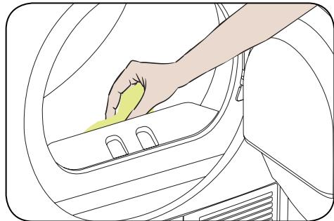
Dentro de la máquina existen sensores de humedad que detectan si la colada está seca o no.
