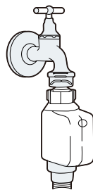
tubo di alimentazione di sicurezza
