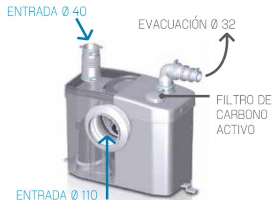
Es un triturador-bombeador especialmente diseñado para evacuar las aguas usadas procedentes de un inodoro de salida horizontal y de un lavamanos. Es para uso doméstico.
