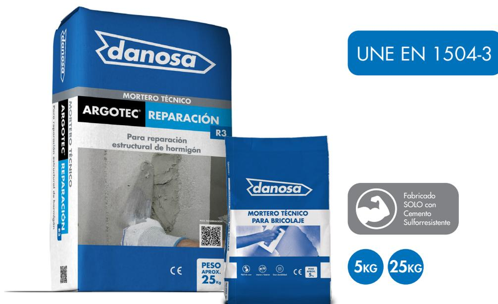
ARGOTEC® REPARACIÓN R3 es un mortero polímero modificado (PCC) tixotrópico, monocomponente, de altas resistencias y sin retracción para reparación estructural de elementos de hormigón, formulado a base de mezcla de conglomerantes hidráulicos, áridos seleccionados, polímeros, inhibidores de la corrosión y fibras que le proporcionan una excelente adherencia y propiedades mecánicas.
