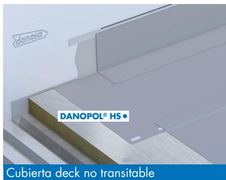
Cubierta deck no transitable
