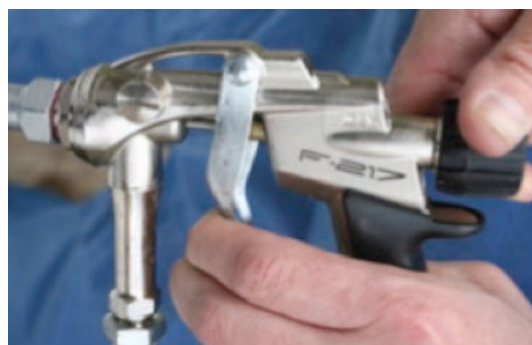
Imagen 3 – Ajuste de difusor para controlar la dispersión del producto
