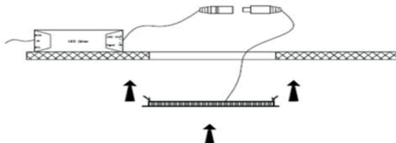
4. Verifique que la lámpara esté bien fijada y que no haya cables atrapados entre la lámpara y el techo.
