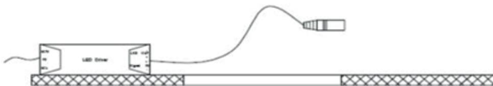
3. Conecte el puerto de entrada de CA del controlador con la fuente de alimentación: el puerto de salida de CC a la lámpara. El controlador requiere una buena ventilación para mantenerlo fresco durante su funcionamiento: asegúrese de que ningún material inflamable o elementos similares que lo rodean estén en contacto con el controlador o el accesorio de iluminación. Coloque la lámpara en el orificio preparado utilizando los clips de fijación proporcionados.
