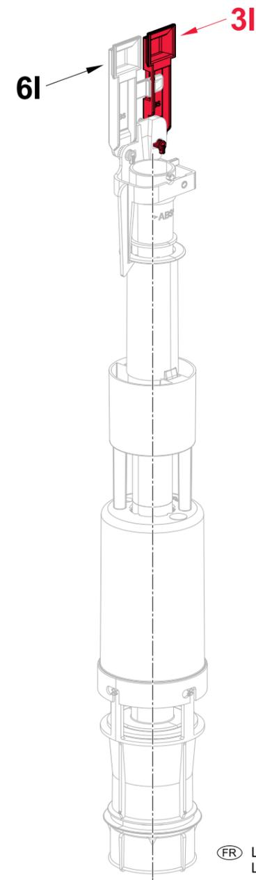
(ESP) Ajuste de descarga pequeña de agua - 3l.
