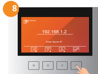
8 Server-IP: dit komt overeen met het lokale IP-adres dat is ingesteld op deurpaneel nummer 1 van gebouw nummer 1. Druk vervolgens op 'Bevestigen'.
