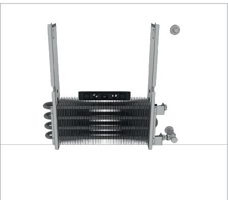
7. Prossiga com a montagem da válvula termostática fornecida na conexão superior do trocador e conecte o tubo interligando a válvula termostática e a conexão da parede. Use chaves fixas e tome cuidado para não deformar o tubo do trocador e o tubo da parede.
