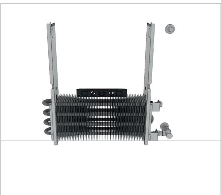
7. Proceda a realizar el montaje de la válvula termostatizable suministrada sobre la conexión superior del intercambiador y conecte la tubería interconectando la válvula termostatizable y la conexión de la pared. Ayúdese de llaves fijas y procure no deformar tanto la tubería del intercambiador como la de la pared.
