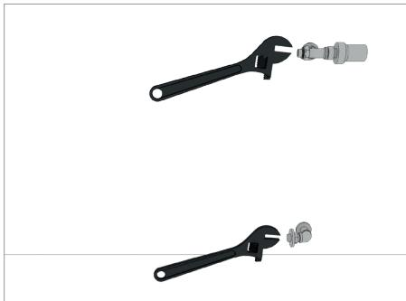
6. Rosque sin apretar el manguito del detentor sobre la conexión inferior del intercambiador del emisor y nivele el equipo señalando sobre el paramento la situación de los taladros previstos para la sujeción de este. Retire el intercambiador desconectándolo del detentor y proceda a realizar los taladros en el paramento y colocar los tacos y tornillos suministrados con el equipo. Cuelgue el intercambiador del emisor y compruebe el nivelado del mismo.
