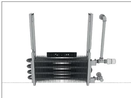
8. Uma vez realizadas estas operações, encha o circuito de aquecimento, purgue o circuito com os dispositivos preparados para o efeito e verifique a existência de fugas. Se houver, aperte levemente as conexões hidráulicas.
