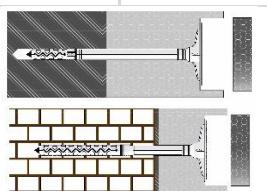
\*En caso de realizar una instalación con avellanado colocar el tapón o parte del aislamiento cortada.
