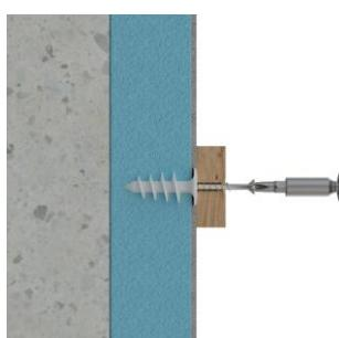
Atornillar a través del elemento a fijar.
