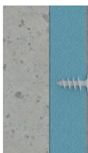
Atornillar hasta que la cabeza quede enrasada con el material aislante.
