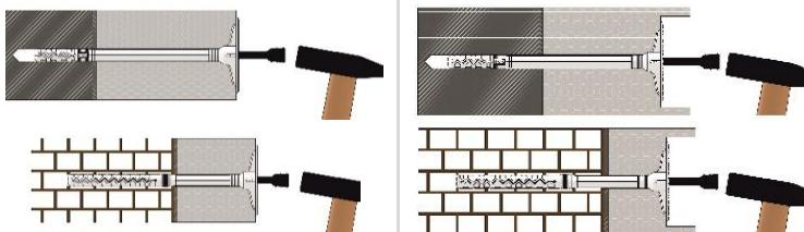
Insertar el clavo en el tajo golpeando sobre éste hasta que el collarín del tajo, toque el material a fijar.
