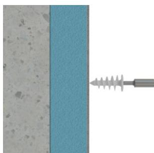
Atornillar el anclaje espiral al material aislante.
