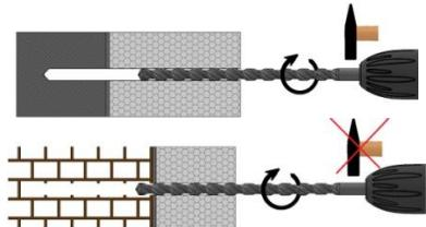
Taladrar al diámetro y profundidad especificada en las tablas anteriores. Taladro en posición percusión o martillo en caso de tratarse de materiales sólidos. En caso de materiales huecos, no emplear el taladro en modo percusión, para evitar dañar el interior del material base. Reducir la velocidad del taladro cuando se sospeche que la salida de la broca se encuentra próxima al interior hueco del material base.
