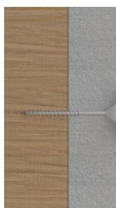
Atornillar a través del material aislante hasta llegar a la madera.
