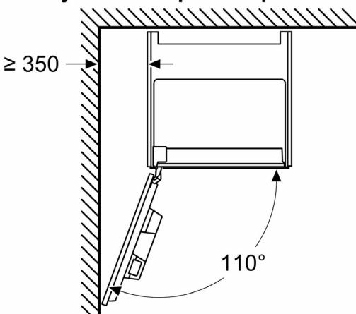
Si se utiliza el limitador de bisagra de 92°, la distancia mín. hasta la pared es de solo 100 mm
