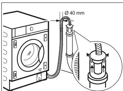
**A un tubo vertical con orificio de ventilación**
