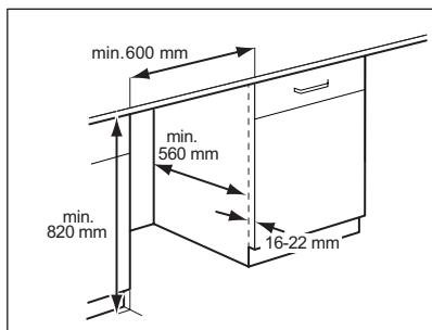
Este aparato está diseñado para integrarse en los muebles de cocina. Vean las dimensiones mínimas del hueco en los dibujos.
