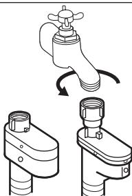
5. Conecte el tubo de entrada de agua fría a una toma de agua fría con rosca de 3/4.
