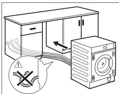
Antes de proceder a integrar el aparato, hacer que lo al hueco y posicione la manguera de entrada, la de desagüe y el cable de alimentación.
