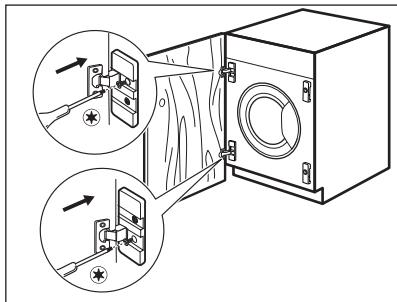
Ajuste la posición del orificio inferior respetando las dimensiones y distancias indicadas en el dibujo (449 mm).
