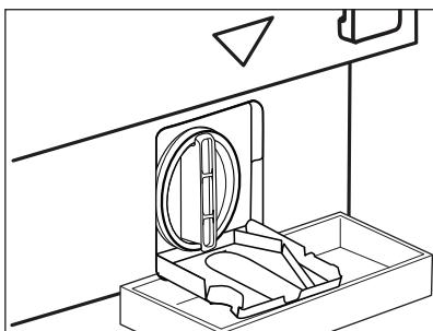
2. Coloque un recipiente debajo de la bomba de desagüe para recoger el agua que salga. Tenga siempre a mano un trapo para secar el agua que se derrame al extraer el filtro.
