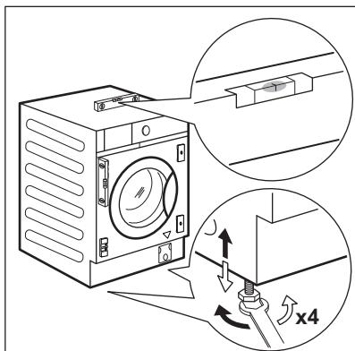
1. Instale el aparato en el suelo sobre una superficie plana y rígida.
