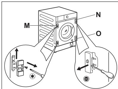
Si la puerta se va a abrir de izquierda a derecha, invierta la posición de los soportes de bisagra **M** con el imán **N** y la placa inferior **O**.
