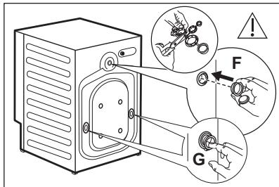
7. Cierre los orificios con los tapones de plástico que encontrará en la bolsa del manual del usuario. Ponga el tapón pequeño **F** en el orificio superior y los dos tapones grandes **G** en los inferiores.
