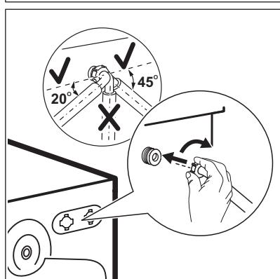
3. Conecte la manguera de entrada de agua a la parte trasera del aparato. No gire en la manguera de entrada hacia abajo, si no hacia la izquierda o derecha según la posición de la toma de agua.
