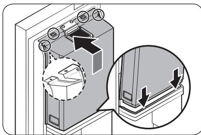
2. Abra la puerta del frigorífico y, a continuación, monte las uniones a presión en la parte inferior y superior de la **cubierta de la Zona de bebidas** en orden. (Orden inverso al del desmontaje)
