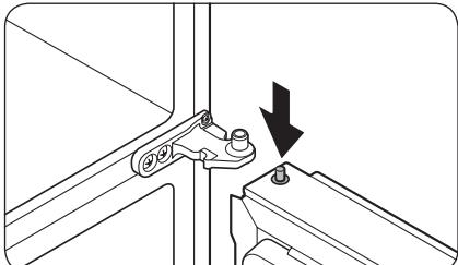
2. Mientras presiona el eje de la bisagra hacia abajo, coloque la puerta de manera que el eje de la bisagra se encuentre por debajo del orificio del eje en la bisagra central. Suelte el eje de la bisagra para que entre en el orificio del eje.
