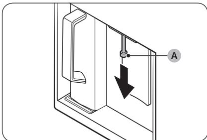
1. Sujete el extremo de la boquilla dispensadora (A).
