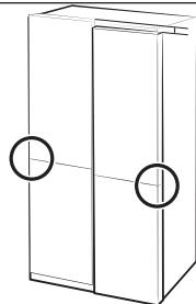
1. Compruebe la diferencia de altura entre las puertas y luego levante y sostenga la puerta a la altura más baja.
