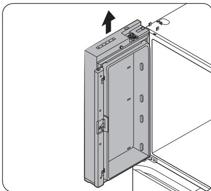
6. Abra la puerta 90 grados. Sujetando la puerta, tire y quite la bisagra superior. Cuando retire la bisagra, tenga cuidado de no dañar los cables del conector.
