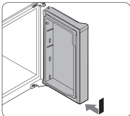
5. Para evitar el contacto con la bisagra central, incline ligeramente la puerta hacia el frente, levántela y retírela.
