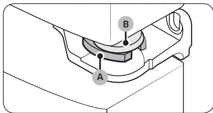
2. Introduzca un anillo elástico (A) del tamaño adecuado entre el ojal de la puerta (B) y la bisagra, como se muestra.
