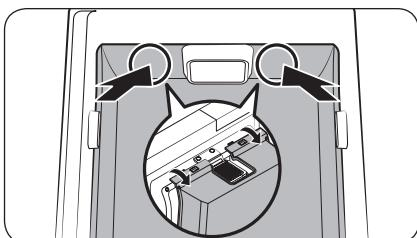
2. Con la puerta con vitrina izquierda abierta, abre la puerta del frigorífico. Luego, empuje la parte superior de la Zona de bebidas (lado izquierdo y derecho del ventilador) desde el interior para liberar las juntas a presión que aseguran la cubierta de la Zona de bebidas a la puerta.
