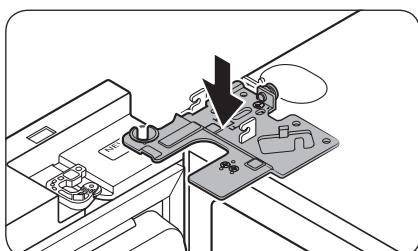
2. Coloque la bisagra superior en su lugar en la parte superior del frigorífico y luego inserte el eje de la bisagra en el orificio superior de la puerta. Asegúrese de que los cables de la puerta pasen por el orificio del eje de la bisagra.
