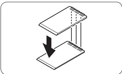
4. Si necesita levantar más la altura de la parte posterior, fije otra almohadilla de ajuste en la parte superior de la primera almohadilla de ajuste de nivel.
