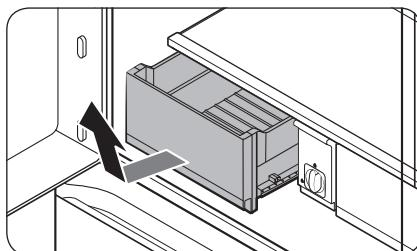
Levante con cuidado la parte frontal del cajón y deslícelo hacia afuera.
