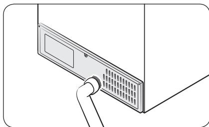
Para mantener limpios los cables y las partes expuestas del panel posterior, aspire el panel una o dos veces al año.
