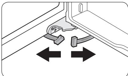
3. Desconecte los conectores de cables.
