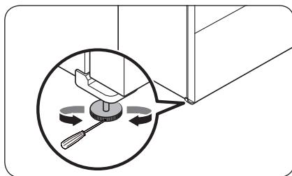
Introduzca un destornillador de punta plana en el nivelador de la pata delantera derecha o izquierda. Gire el nivelador en el sentido de las agujas del reloj para subir y en el sentido contrario al de las agujas del reloj para bajar.
