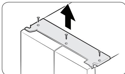
1. Con las puertas cerradas, retire los tornillos (3) de la cubierta superior con un destornillador Phillips. Levante y retire la cubierta superior con los conectores.
