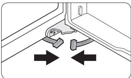
3. Con la puerta abierta, conecte los conectores inferiores en la dirección de las flechas.
