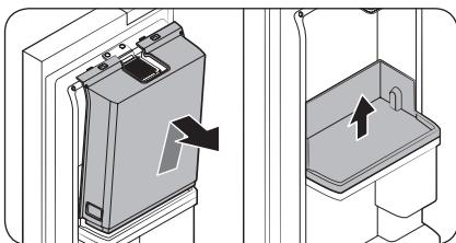
3. Si se liberan las uniones a presión en la parte superior, sostenga la cubierta de la Zona de bebidas y levántela para retirarla.
