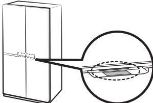
Toque el sensor cerca del tirador de la puerta del frigorífico. La puerta se abre.
