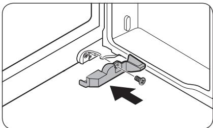
4. Monte la cubierta con un destornillador Phillips. Tenga cuidado de no dañar ni pisar los conectores.
