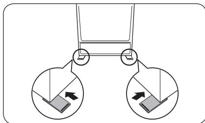
Si necesita levantar la parte posterior del frigorífico para nivelarla, puede usar las almohadillas de ajuste de nivel que se proporcionan. Siga estas instrucciones para levantar la parte posterior del frigorífico.
