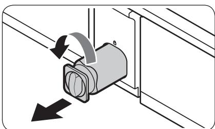
3. Gire la palanca del cartucho del filtro en el sentido contrario al de las agujas del reloj 90 grados (giro de  $\frac{1}{4}$ ). El cartucho del filtro se desbloquea.
