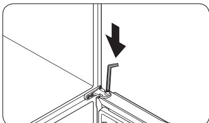
4. Localice el eje de la bisagra. Mientras sujetla la puerta con una mano, presione el eje hacia abajo con un destornillador de punta plana o una llave Allen. Sujete bien la puerta para evitar que se caiga.
