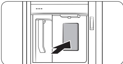
Para dispensar agua fría, abra el centro de bebidas y presione la palanca del dispensador.
