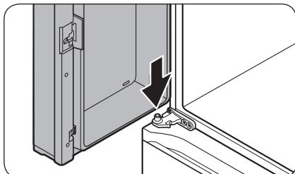
1. Mientras mantiene la puerta abierta más de 90 grados, inserte el eje de la bisagra central en el orificio de la parte inferior de la puerta.
