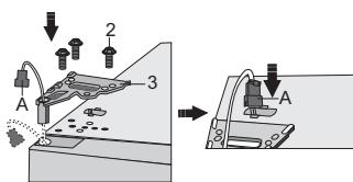
Colocar correctamente la puerta superior, pasar el conector (A) por el orificio de la bisagra superior (3) y ajustar con los tornillos (2). Sostenga la puerta superior en su lugar mientras la posiciona. Volver a conectar el conector (A).
