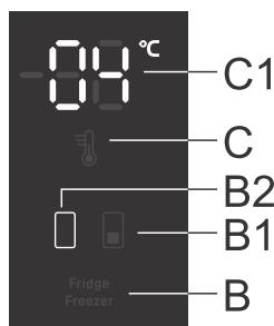
La temperatura en el cajón **cajón refrigerador** se puede configurar cuando el símbolo **B2** esté iluminado. Ajuste la temperatura pulsando brevemente el botón **C**.
