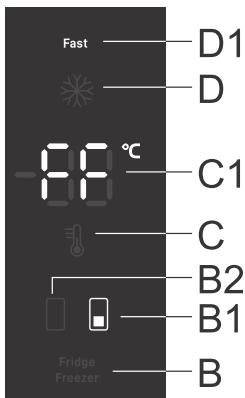
**Apagado:** si el compartimento frigorífico está activo (**B2** se enciende), luego presione primero el botón **B** para cambiar al compartimiento del congelador(**B1** se iluminará), y luego presione el botón **D** para desactivar la función.
