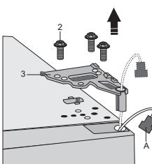
Desatornillar los tornillos (2) y retirar la bisagra (3). Pasar el conector (A) por el orificio de la bisagra. Sujetar la puerta durante el procedimiento para evitar que se caiga.
