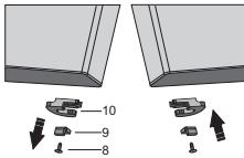
Colocar la puerta inferior sobre una superficie lisa. Desenroscar el tornillo (8) y retirar el retenedor de la puerta (10) y el tope de la puerta (9). En el lado opuesto utilizar el tornillo (8) para instalar el retenedor de la puerta suministrado en la bolsa, y el tope de la puerta (9). Guardar el retenedor de la puerta (10) por si lo necesita más tarde.
