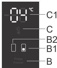
En este modelo, puede cambiar entre configurar la temperatura del refrigerador y la temperatura del compartimiento del congelador. Para ello, pulse el botón **B**. El símbolo del compartimento deseado se iluminará: **B1** para el compartimiento del congelador y **B2** para el compartimento de refrigeración.
