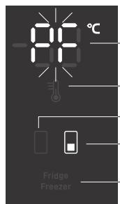
Si la temperatura en el aparato alcanzó el nivel de alarma durante el corte de energía, la alarma de alta temperatura se activará cuando se restablezca la fuente de alimentación. Se activará la alarma acústica, y **PF** parpadeará en la unidad de visualización **C1**.
