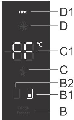
**Para activar:** presione la tecla **D** para activar la función de congelación intensiva (super freeze). Escuchará un pitido y los indicadores **B1** y **D1** se iluminarán. **FF** aparecerán en la unidad de visualización **C1**. **FF** se iluminará mientras la función esté activa si la pantalla **B1** se selecciona con el botón **B**.
