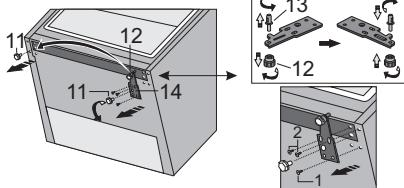
Afloje los tres tornillos de la bisagra inferior (14) y extraígala. Retire la pata adicional (12) del pasador de la bisagra inferior (13). Desatornille el pasador (13) de la bisagra inferior y atornílelo en el lado opuesto de la bisagra, junto con la pata adicional (12).
