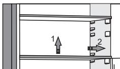
Puede colocar los estantes vacíos a su gusto utilizando las guías que hay en el interior del frigorífico sin tener que sacarlos del frigorífico. Para mover el estante o sacarlo del frigorífico, levántelo ligeramente por la parte trasera, tire de él hacia usted, y luego muévalo o sáquelo del electrodoméstico. Almacene los alimentos perecederos en la parte posterior del estante donde la temperatura es más baja.
