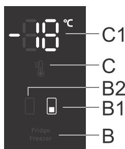
La temperatura en el cajón **congelador** se puede configurar cuando el símbolo **B1** esté iluminado. Ajuste la temperatura pulsando brevemente el botón **C**.
