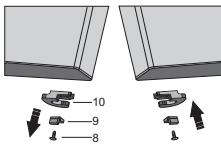
Desenroscar el tornillo (8) y retirar el retenedor de la puerta (10) y el tope de la puerta (9). Luego, utilizar el tornillo (8) para instalar el retenedor de la puerta suministrado en la bolsa, y el tope de la puerta (9). Guardar el retenedor de la puerta (10) por si lo necesita más tarde.
