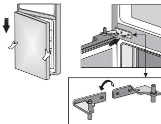
Colocar la puerta inferior en la bisagra inferior y manténgala en su lugar. Girar la bisagra central 180°. Colocar la arandela en la posición correcta y ajustar la posición de la bisagra central para poder instalar y fijar la puerta inferior.
