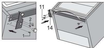
Fije la bisagra (14) en el lado opuesto, con los tornillos. Los tornillos deben colocarse en el orden que se muestra en la siguiente figura. Primero, ajuste el tornillo 1, seguido de los tornillos 2. Luego, atornille las patas ajustables (11).
