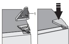
Volver a colocar la tapa de la bisagra superior (1).
