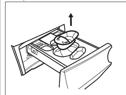
3. Levanta la cubierta superior de los compartimentos para extraerla.
