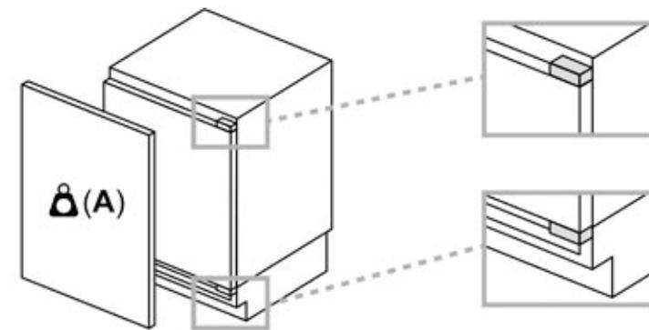
Los frontales instalados en la unidad que superen el peso permitido pueden causar daños y afectar al funcionamiento de las bisagras
