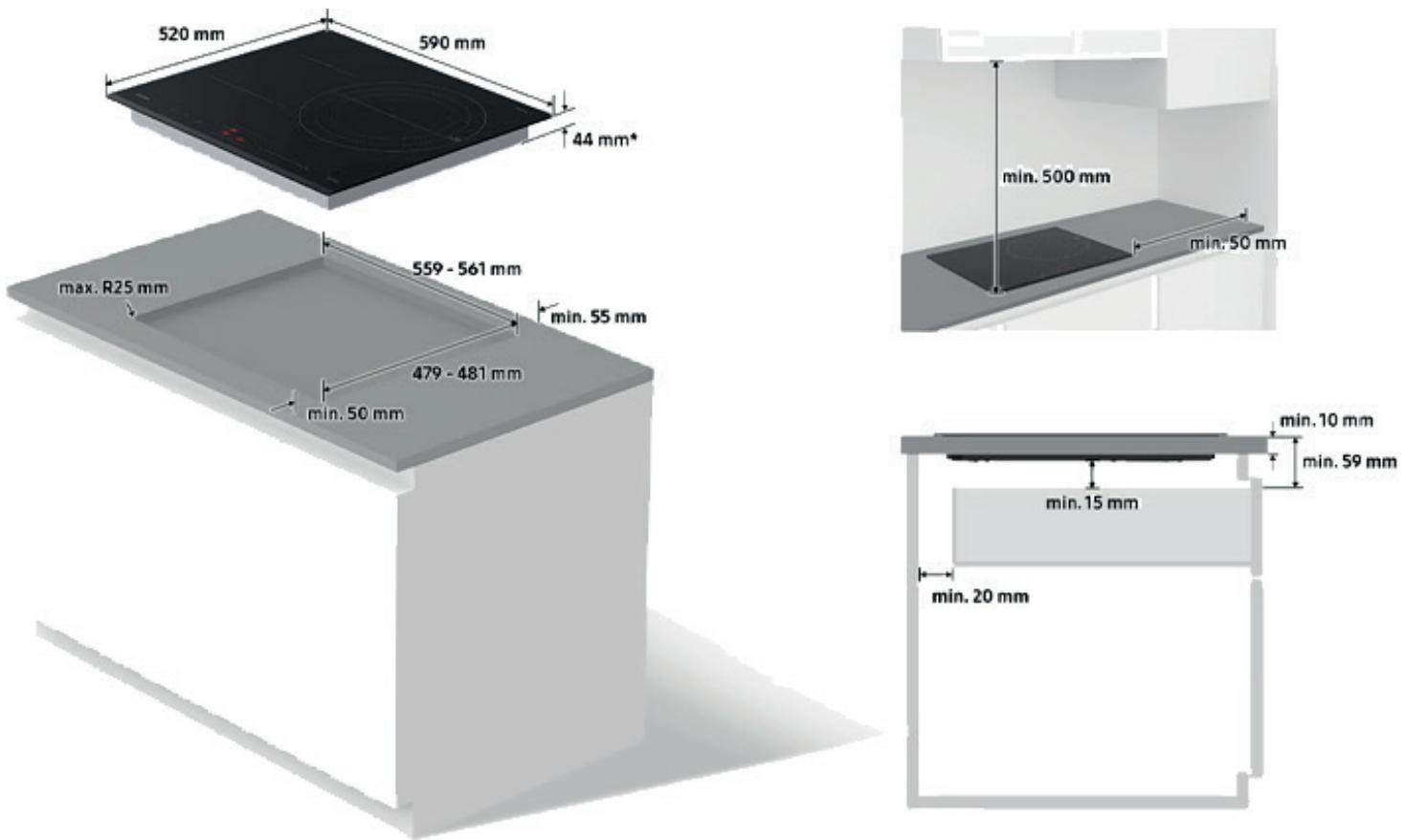
\* La altura de la placa es de 44mm, sin incluir el cristal cerámico que tiene un grosor de 4mm.
