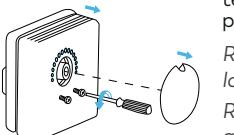
Extrae la rueda de regulación de temperatura y afloja el tornillo de la carcasa para retirarla.
