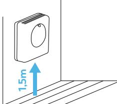
Coloca el termostato en la pared verticalmente, a una altura aproximada de 1.5m del suelo. Esta ubicación permitirá un flujo adecuado de aire y una medición precisa de la temperatura ambiente. Asegúrate de instalar el termostato en un lugar que no esté expuesto directamente a los rayos del sol. Además, manténlo alejado de cualquier equipo de cocina u otros dispositivos que generen calor.
