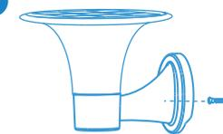
4. Instala el tornillo antirrobo M3x25mm para fijar la lámpara a la base de pared.
