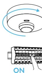
Enrosca la tapa y conecta la alimentación eléctrica. Luego, sigue los pasos del apartado Test para finalizar la instalación.
