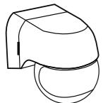
Conecta la alimentación eléctrica. La luz se encenderá transcurridos 30 segundos y, posteriormente, se apagará transcurridos 10 segundos. Si el detector vuelve a detectar presencia, funcionará con normalidad.
