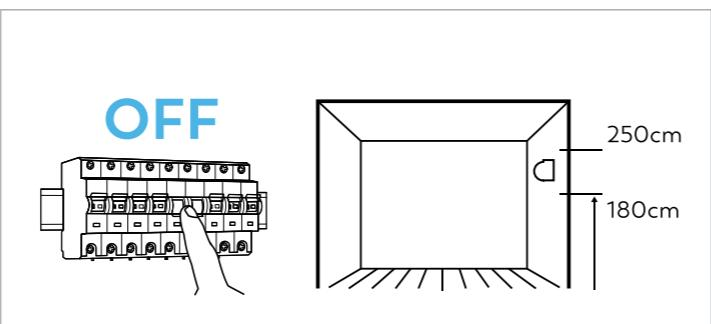
Desconecta la alimentación eléctrica y elige un lugar adecuado para la instalación del detector, a una altura de entre 1.8 y 2.5m.
