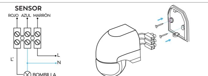
Conecta los cables según lo indicado en el diagrama. Recuerda que tanto el detector como la bombilla deberán recibir ambos alimentación desde el cable neutro (N - normalmente azul) de tu instalación eléctrica. Para ello, puedes ayudarte de una clema si lo necesitas. Encaja el detector en la tapa previamente fijada. Conecta de nuevo la alimentación eléctrica y sigue los pasos indicados en el apartado Test para concluir la instalación.
