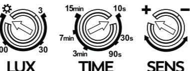
La luz recibida por el detector puede activar el encendido de la luminaria conectada. Funcionará con luz y oscuridad si se ajusta en la posición “
