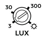
Una vez finalizada la prueba gira el interruptor LUX al mínimo (3), de forma que el dispositivo manda la señal de encendido a la luminaria solo si la luz ambiente es menor a 3 LUX.
