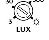
Recuerda mantener el interruptor LUX al máximo ☼ si la prueba se está llevando a cabo durante el día. De lo contrario, la prueba no funcionará.
