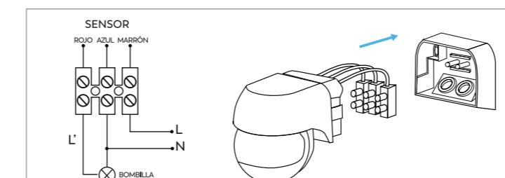
Conecta los cables según lo indicado en el diagrama, siendo L el cable fase (normalmente marrón) de tu instalación eléctrica, N el cable neutro (normalmente azul) de tu instalación eléctrica, L'⊗ el cable fase (normalmente marrón) de tu luminaria y haciendo de N'⊗ (normalmente azul) el cable neutro de la luminaria.
