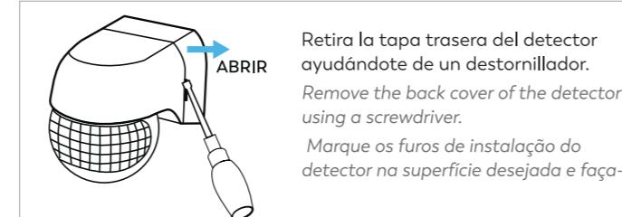
Retira la tapa trasera del detector ayudándote de un destornillador.
