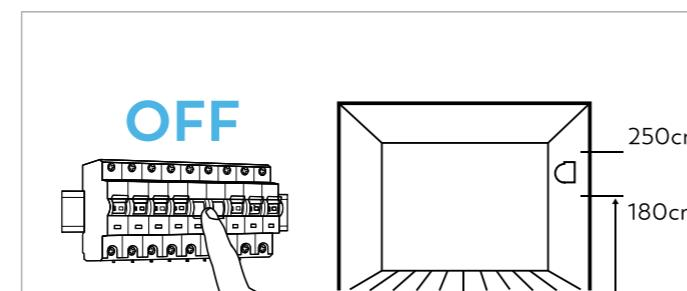
Desconecta la alimentación eléctrica y elige un lugar adecuado para la instalación del detector, a una altura de entre 1.8 y 2.5m.
