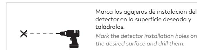
Marca los agujeros de instalación del detector en la superficie deseada y taládralos.
