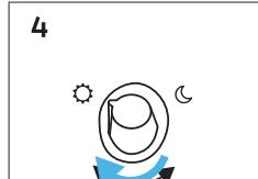
Una vez finalizada la prueba gira el interruptor LUX al mínimo (○), de forma que el dispositivo mande la señal de encendido a la luminaria solo si la luz ambiente es menor a 3 LUX.
