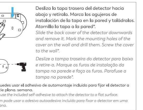
Desliza la tapa trasera del detector hacia abajo y retírala. Marca los agujeros de instalación de la tapa en la pared y taládralos. Atornilla la tapa a la pared\*.
