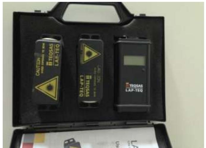
Inclinómetro que se fija en el soporte de colgado y lector. **TEQSAS LAP-TEQ**
