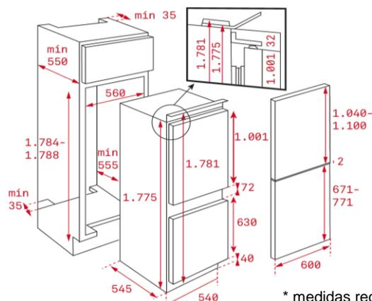
\* medidas recomendadas para muebles de espesor 16 mm y 2 mm de separación entre puertas
