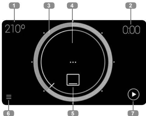
1. Συνιστώμενη θερμοκρασία μαγειρέματος. Πατήστε το για να μεταβείτε στην οθόνη επιλογής θερμοκρασίας μαγειρέματος.
