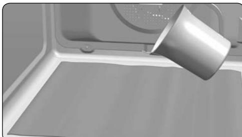
Versez lentement 200 ml d'eau sur la partie inférieure de la cavité du four.
