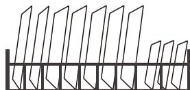
Der empfohlene maximale Durchmesser für Teller, die direkt vor dem Spülmittelbehälter einsortiert werden, beträgt 19 cm, damit sich der Spülmittelbehälter ungehindert öffnen kann.
