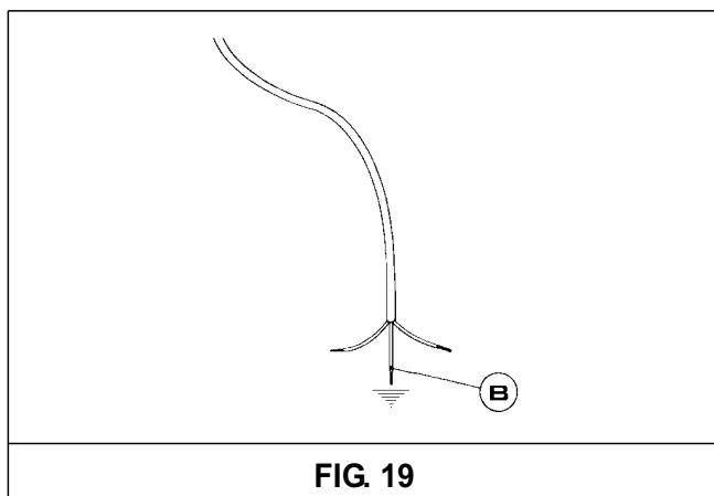
**Em caso de falha ou corte no cabo, por favor, afastar-se do cabo e não tocá-lo. Além disso, o dispositivo deve ser desligado e não ligado. Ligue para o centro de serviço autorizado mais próximo para corrigir o problema.**
