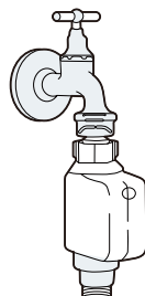
tubo di alimentazione di sicurezza
