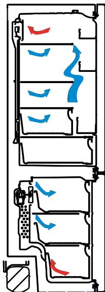
La situation est complètement différente dans les compartiments de congélation équipés d'une technologie de refroidissement de nouvelle génération. À l'aide d'un ventilateur, de l'air froid et sec est ventilé à travers le compartiment de congélation. L'air froid ventilé passe facilement à travers du compartiment, et même dans les espaces entre les étagères, ce qui permet de congeler les aliments de manière uniforme. Votre congélateur ne givre plus.
