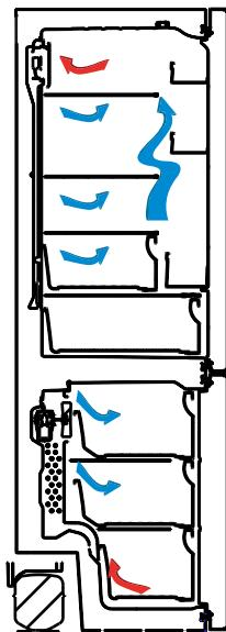
Mit der Kühltechnologie der neuen Generation sieht die Situation im Gefrierteil ganz anders aus. Mit einem Lüfter wird an mehreren Stellen kalte, trockene Luft in das Gefrierteil geblasen. Durch die gleichmäßig verteilte kalte Luft, die sogar bis in die Freiräume zwischen den Fächern gelangt, wird das Gefriergut gleichmäßig und richtig gefroren. Darüber hinaus bildet sich so kein Reif.
