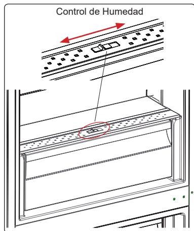
Si el cajón para fruta y verdura está lleno, el control de Humedad ubicado en la parte frontal del cajón debe dejarse abierto. De este modo se controla el aire y la humedad que hay dentro del cajón para aumentar la vida de los alimentos que haya en su interior.
