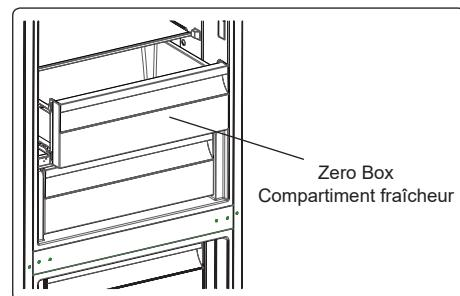
Le fait de conserver de la nourriture dans le compartiment Zero Box plutôt que dans les compartiments congélateur ou réfrigérateur, permet de maintenir la fraîcheur et la saveur des aliments plus longtemps, tout en préservant leur aspect frais. Lorsque le plateau du compartiment Zero Box est sale, le retirer et le laver à l'eau.
