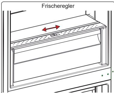
Bei vollem Gemüsefach sollte der Frischeregler vorne am Gemüsefach geöffnet werden. So kann die Luft und die Feuchtigkeit im Gemüsefach reguliert werden, um die Haltbarkeit der Lebensmittel im Fach zu verlängern. Wenn sich Kondenswasser am Glasablauffach bildet, muss der Frischeregler hinter dem Fach geöffnet werden.
