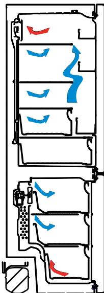
detrás del conducto de aire. Al mismo tiempo, se expulsa aire por los orificios del conducto de aire para que el proceso de refrigeración se complete debidamente en el refrigerador. Los orificios del conducto de aire están diseñados de tal modo que la distribución de aire sea homogénea en este compartimento.
