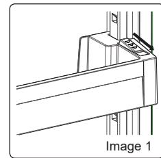
Positionner le balconnet à la hauteur requise en le déplaçant vers le haut et le bas. Une fois le balconnet à la position souhaitée, relâcher les languettes situées sur les côtés (Image 2). Avant de lâcher le balconnet, exercer une pression vers le haut et le bas pour s'assurer qu'il est parfaitement en place.
