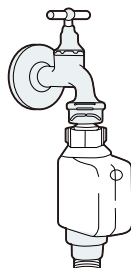
tubo di alimentazione di sicurezza
