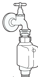
ống cấp an toàn
