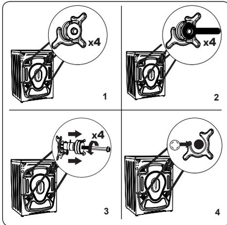
1. Entfernen Sie vor Inbetriebnahme der Waschmaschine unbedingt die 4 Transportschrauben und Gummiabstandhalter an der Rückseite des Gerätes. Falls die Schrauben nicht entfernt werden, können sie starke Vibrationen, Geräusche und Fehlfunktionen des Gerätes verursachen und die Garantie erlöschen lassen.
