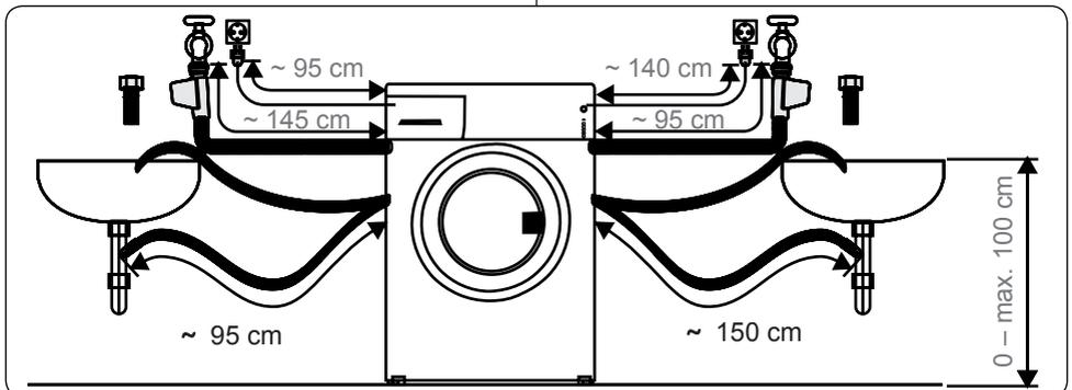
**NOTA:** La lavadora solo debe conectarse al suministro de agua mediante la nueva manguera de llenado proporcionada. No se deben reutilizar mangueras antiguas.
