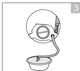
Po całkowitym wypłynięciu wody ponownie włożyć wąż spustowy
