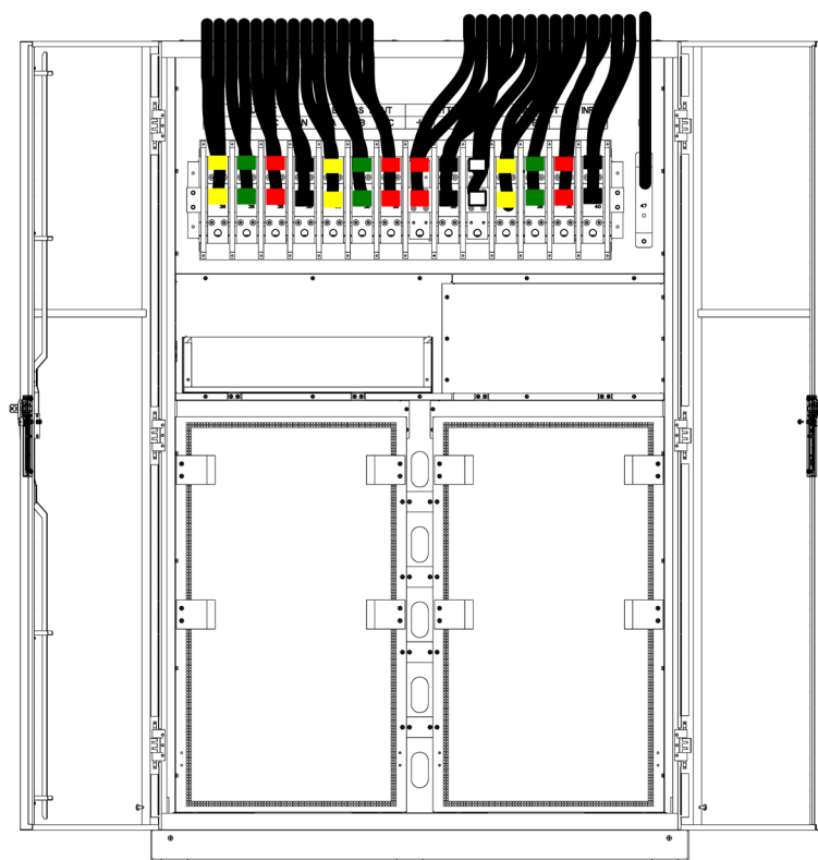
Fig. 36. Instalación armario de 10 slots con la entrada de cables por la parte superior (visión posterior).
