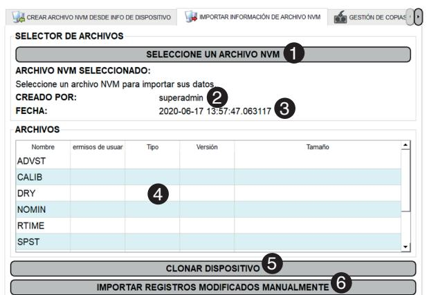
La importación de los ficheros NVM a un equipo está pensada para analizar los datos recogidos en otro equipo a tiempo real o para establecer los parámetros de los ficheros en nuestro equipo "clonando" así el equipo original.
