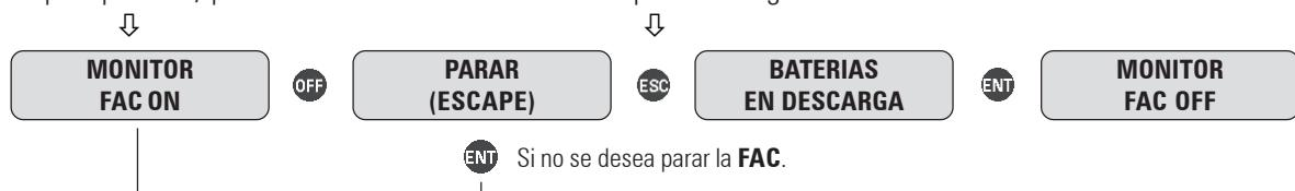
**Nota:** La tecla OFF y ESC físicamente es un mismo elemento, y aparece en la serigrafía del sinóptico como ESC/OFF. El hecho de que en esta figura se indiquen como elementos distintos, no tiene otra finalidad que la de indicar la función correspondiente a la acción a realizar.
