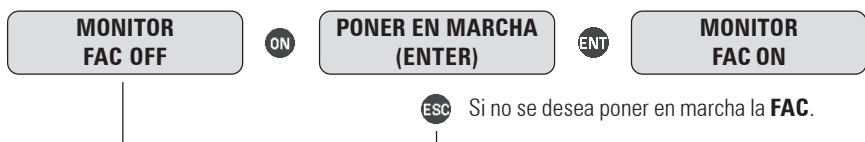
**Nota:** La tecla ON y ENT físicamente es un mismo elemento, y aparece en la serigrafía del sinóptico como ENT/ON. El hecho de que en esta figura se indiquen como elementos distintos, no tiene otra finalidad que la de indicar la función correspondiente a la acción a realizar.
