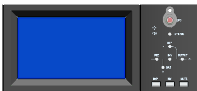
Panel de supervisão instalado em sub racks de seis slots.
