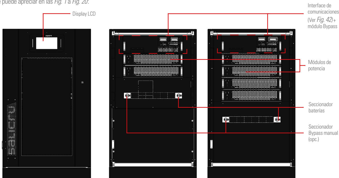
Fig. 1. Vistas frontales del armario de 24U, con puerta cerrada (izd.) y con puerta abierta entre 2 y 4 módulos instalados de 10 y 15 kVA (centro y dcha. respectivamente).
