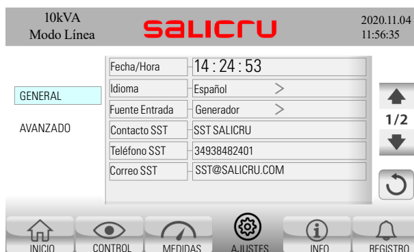
Fig. 54. Pantalla de configuración para la primera puesta en marcha.
