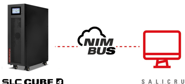
Fig. 68. Sistema de monitorización remota y de avisos directo al Servicio Técnico, el tiempo de respuesta se minimiza al máximo.
