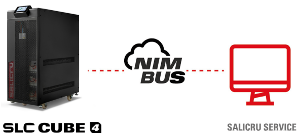
Fig. 71. Système de surveillance à distance et notifications directes au service technique, le temps de réponse est minimisé au maximum.
