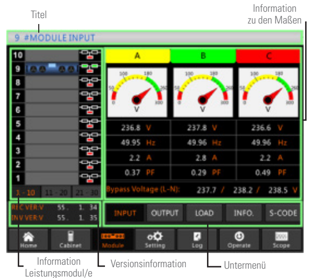
Abb. 54. Informationsmenü zum Modul oder den Leistungsmodulen. Untermenü Eingang.
