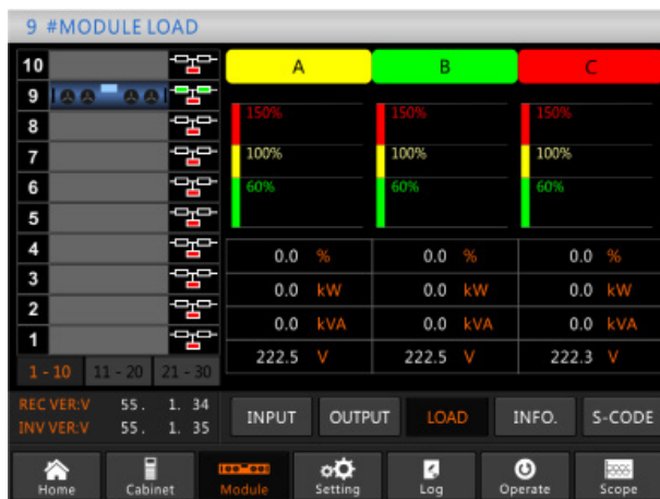
Abb. 56. Informationsmenü zum Modul oder den Leistungsmodulen. Untermenü Last.
