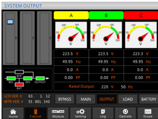
Abb. 51. Informationsmenü des Schaltschranks. Untermenü Ausgang.
