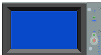
Panel de supervisión instalado en sub-racks de 2 y 4 slots.
