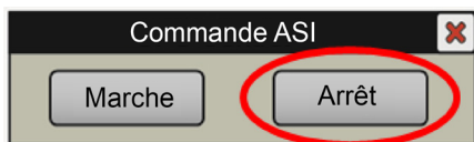
Fig. 62. Fenêtre émergente « Commande ASI ». Cliquer sur « Arrêt »
