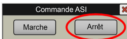
Fig. 55. Fenêtre émergente « Commande ASI ». Cliquer sur « Arrêt »
