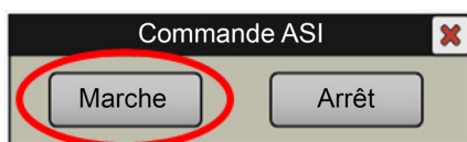
Fig. 60. Fenêtre émergente « Commande ASI ». Cliquer sur « Marche ».
