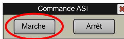
Fig. 63. Fenêtre émergente « Commande ASI ». Cliquer sur « Marche ».
