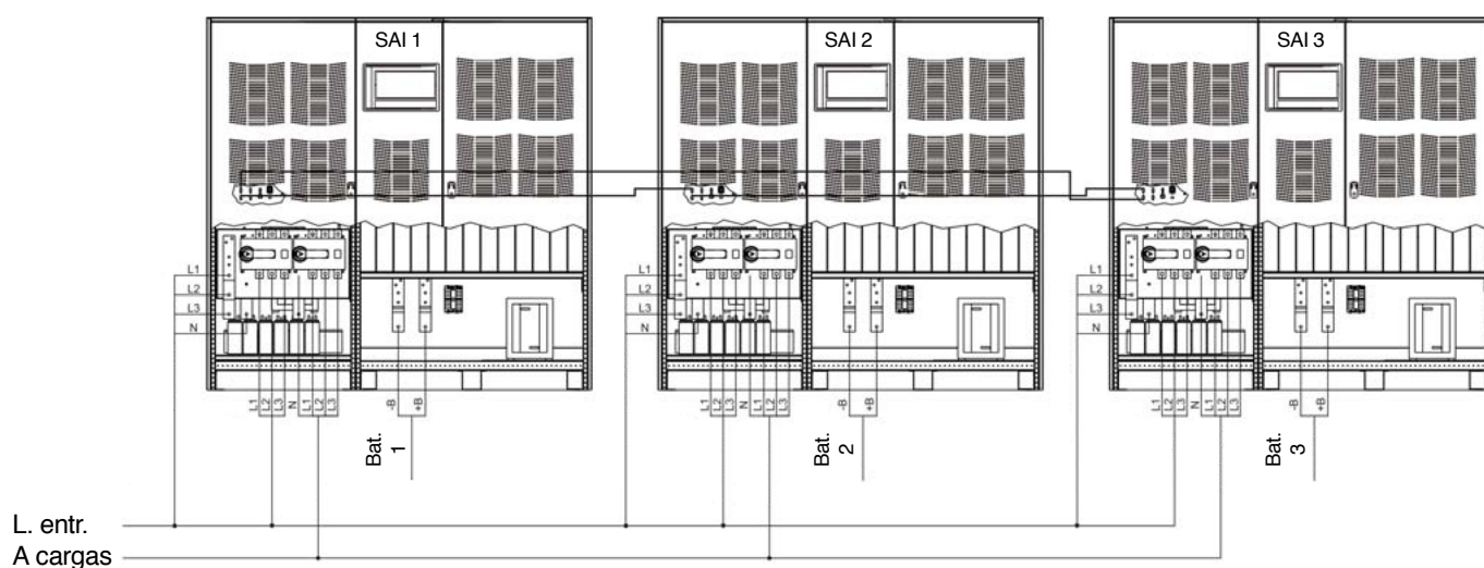
Fig. 26. Ejemplo conexión 3 SAI XTRA-P de 400 kVA.
