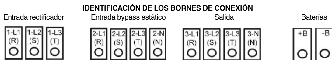
Fig. 17. Disposición de bornes para SAI de 100 a 160 kVA.
